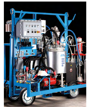
WIWA DUOMIX 333 PFP ATEX, для вспучивающегося огнезащитного материала
