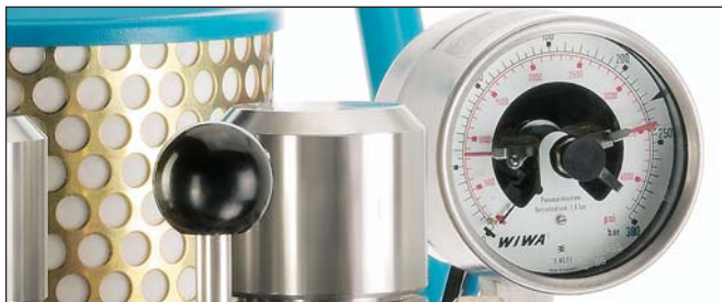
Следящая система рабочего давления и соотношения смешивания
