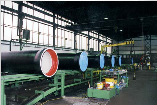
Наружнее и внутреннее покрытие труб
